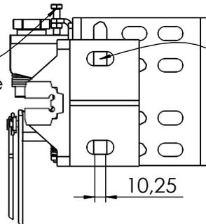
В монтажных отверстиях опор отрегулируйте направляющие колодки в зависимости от размера каждой колодки (стр. 2).
